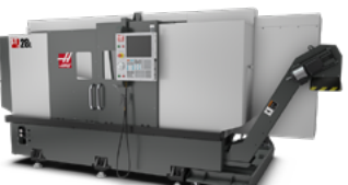
ST-28L LONG BED • Max Cut Ø 330 x L 1,080 mm • Bar Capacity 102 mm • A2-8 • 3,200 rpm • 40 hp • Chuck 305 mm
