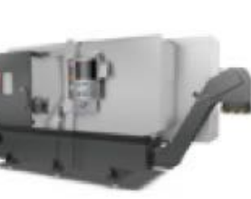
ST-30 • Max Cut Ø 381 x L 826 mm • Bar Capacity 76 mm • A2-6 • 3,400 rpm • 30 hp • Chuck 254 mm
